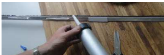
Per fissare lo spazzolino si usano dei pezzi di nastro biadesivo alternati a cordoli di MS Polimero
