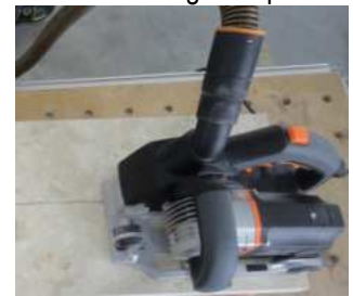
Lo scanalatore aspirato della ditta Protool
